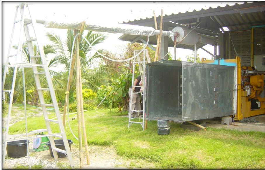
ภาพที่ 7 การตรวจวัดประสิทธิภาพการใช้พลังงานของเครื่องยนต์ผลิตกระแสไฟฟ้าก๊าซชีวภาพ
