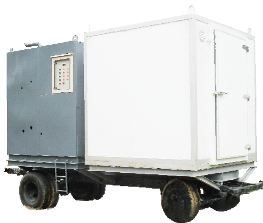
ข: ระบบทำความเย็นแบบดูดซึมและห้องเย็น
