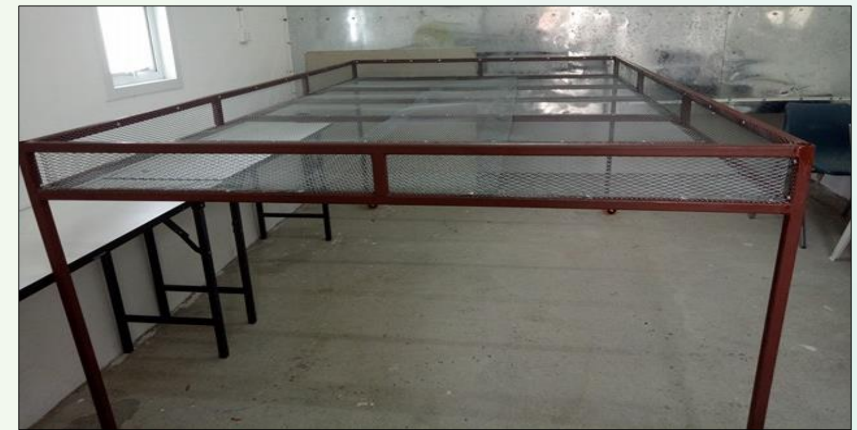
รูปที่ 7 ตะแกรงเหล็กวางผลิตภัณฑ์ รูปที่ 7 เป็นตะแกรงเหล็กวางผลิตภัณฑ์ สร้างจากเหล็กกล่องขนาด 1.91 cm x 1.91 cm หนา 0.20 cm สำหรับวางผลิตภัณฑ์ทางการเกษตร
