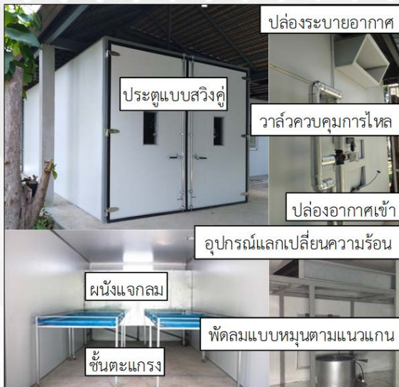
รูปที่ 2 ลักษณะของห้องอบแห้งแบบรวมศูนย์เมื่อแล้วเสร็จ
