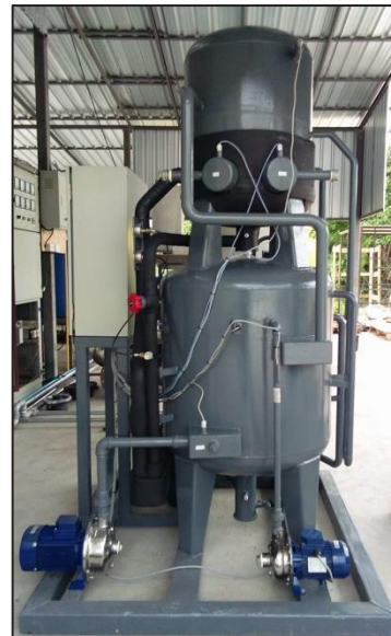
รูปที่ 7 ระบบทำความเย็นแบบดูดกลืนขนาดประมาณ 1 TR
