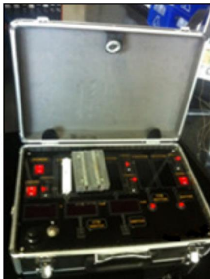
ก) แผงโมดูลวงจรกำเนิดแสง LED ข) ชุดทดสอบวงจร LED รูปที่ 4 อุปกรณ์การทดสอบการเปลี่ยนแปลงแรงดันไฟฟ้ากระแสตรง
