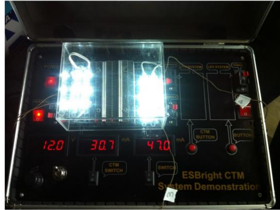
รูปที่ 8 การทดสอบการเปลี่ยนแปลงอุณหภูมิโดยรอบที่มีผลต่อโมดูลกำเนิดแสงแบบ LED
